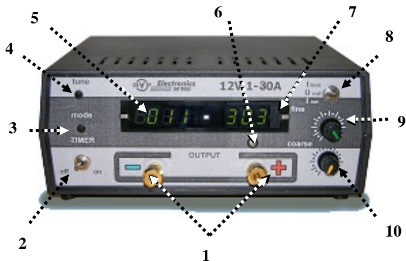
Рис. 2. Расположение органов управления на передней панели источника питания
