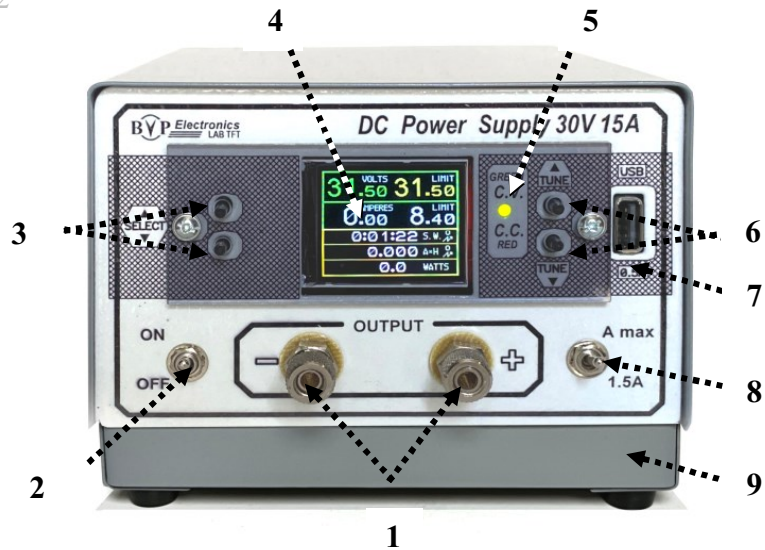
Мал. 2. Розташування органів управління на передній панелі джерела живлення
