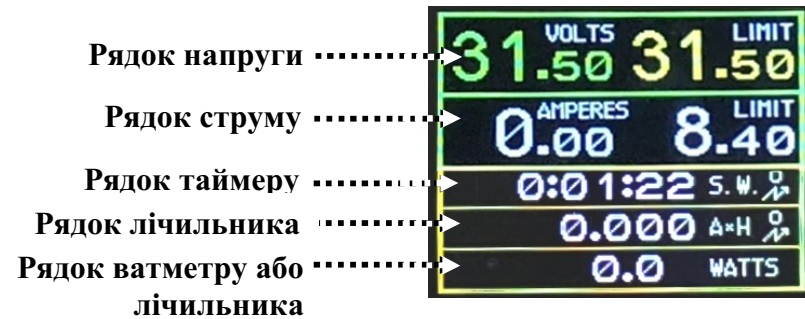
Мал. 3. Відображення інформації на дисплеї джерела живлення
