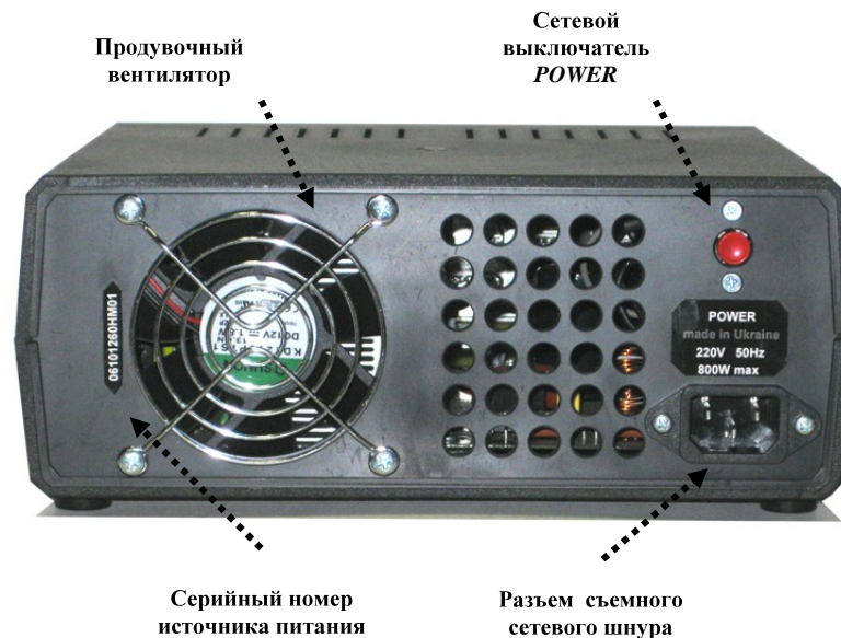
Рис. 3. Расположение органов управления на задней панели источника питания
